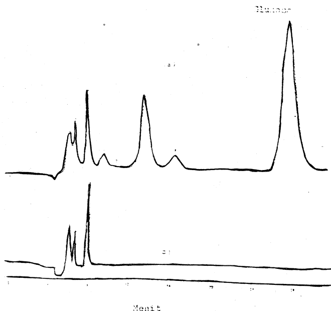
Gambar 5. Pemisahan HPLC dari hidrolisat pati hidroksipropil (a) sebelum dan (b) sesudah melewati kolom Dowex SBR ( \text{OH}^- )
