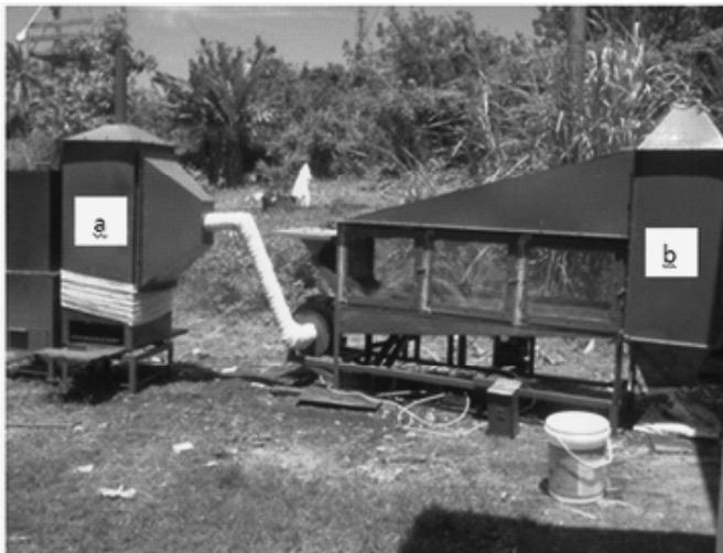
Gambar 2. Prototipe alat pengering CFVFB: (a) unit tungku biomassa, (b) unit pengering
