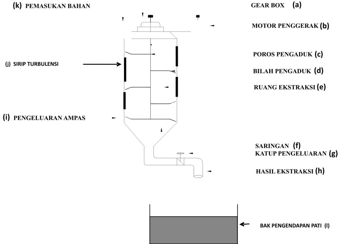
Gambar 1. Konstruksi alat pengestrak pati sagu tipe *mixer rotary blade*
