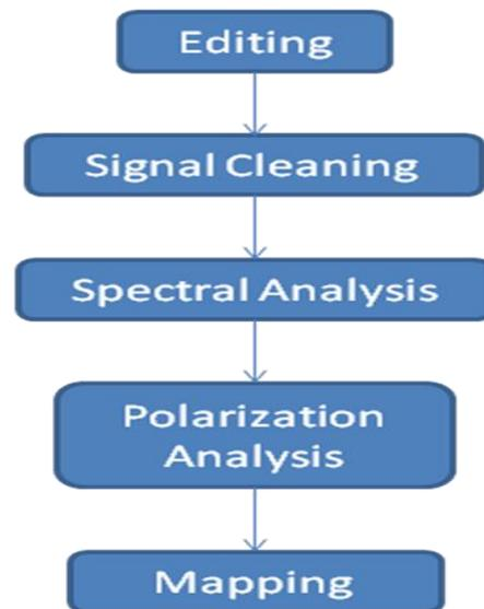
Gambar 6. Diagram alir pengolahan data mikroseismik.
