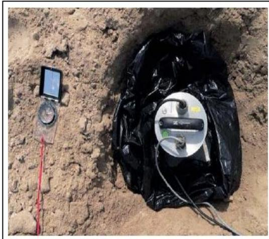
Gambar 5. Instalasi seismometer *broadband* di lapangan.
