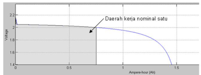
Gambar 8. Simulasi model karakteristik baterai asam Pb dengan Simulink/Matlab
