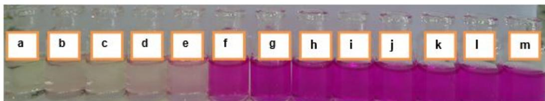
Fig 11. Color change LOD of sensor 1; a. 0 eq, b.  $10^{-5}$  eq, c.  $10^{-4}$  eq, d.  $10^{-3}$  eq, e.  $10^{-2}$  eq, f.  $10^{-1}$  eq, g. 1 eq, h. 5 eq, i. 10 eq, j. 30 eq, k. 50 eq, l. 70 eq, m. 90 eq
