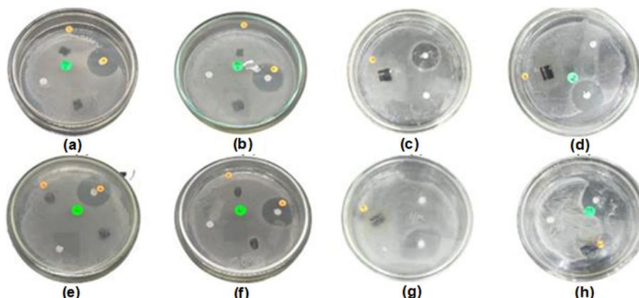
**Fig 5.** Bacterial test films: (a) PVA/CH/AN 10% *E. coli*, (b) PVA/CH/AN 10% *S. aureus*, (c) PVA/CH/AN 40% *E. coli*, (d) PVA/CH/AN 40% *S. aureus*, (e) PVA/CH/GS/AN 5% *E. coli*, (f) PVA/CH/GS/AN 5% *S. aureus*, (g) PVA/CH/GS/AN 40% *E. coli*, and (h) PVA/CH/GS/AN 40% *S. aureus*
