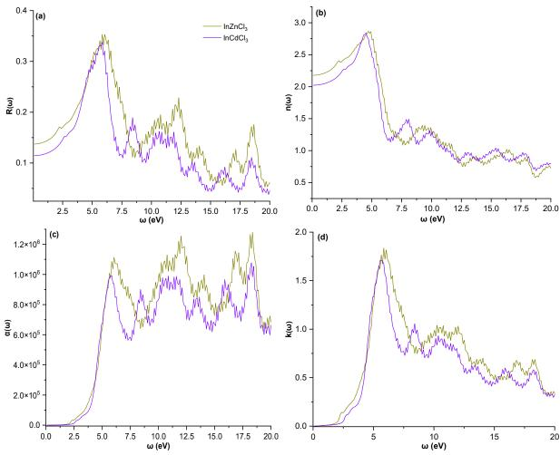
Fig 8. (a)  $R(\omega)$ , (b)  $n(\omega)$ , (c)  $\alpha(\omega)$ , and (d)  $k(\omega)$  of cubic  $InZnCl_3$  and  $InCdCl_3$  perovskites
