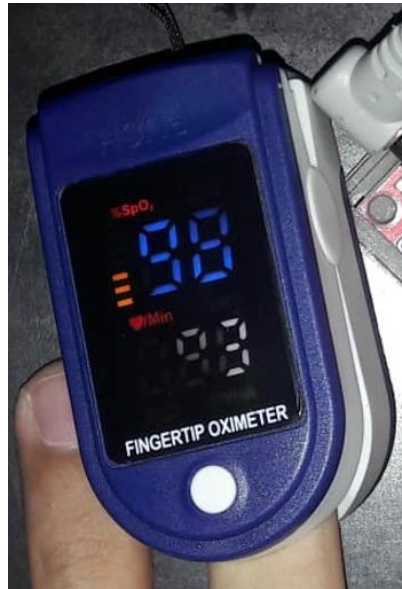
Gambar 11 Hasil Pengukuran Oximeter (98% kadar SpO2 dalam darah)
