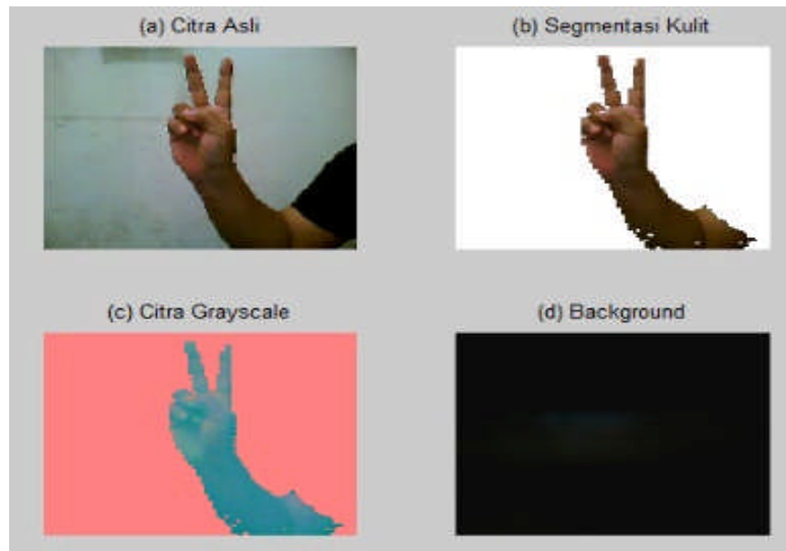
Gambar 3 Tahapan deteksi objek metode segmentasi warna kulit YcbCr
