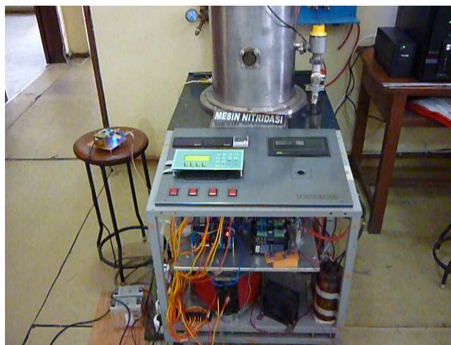
Gambar 5 Mesin nitridasi plasma yang telah dirangkai dengan sistem instrumentasi dan kendali
