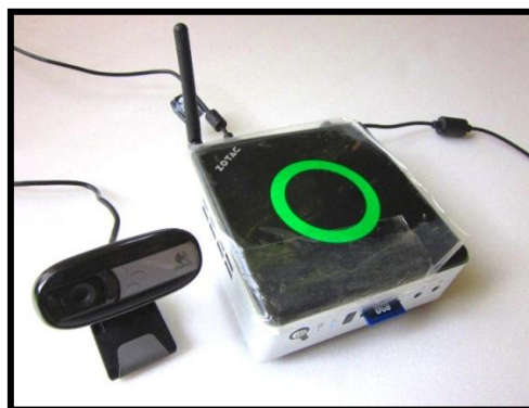
Gambar 3. Implementasi perangkat keras pada server
