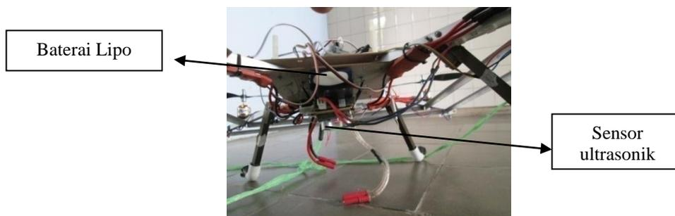
Gambar 6 implementasi *Power supply* dan sensor ultrasonik
