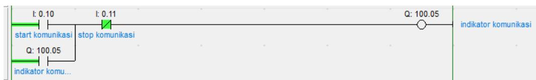
Gambar 9 Program *ladder* sederhana untuk mengecek komunikasi PLC dengan CX-Programmer
