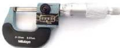
Gambar 10. Mikrometer
