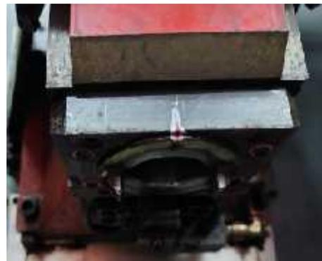
**Gambar 6.** Toolholder pada Mesin CNC EMCO VMC-200
