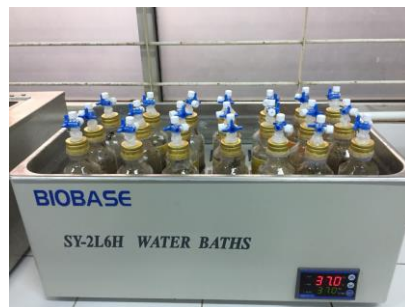
Gambar 4. Penggunaan Botol Kaca Bekas sebagai Reaktor pada Uji BMP
