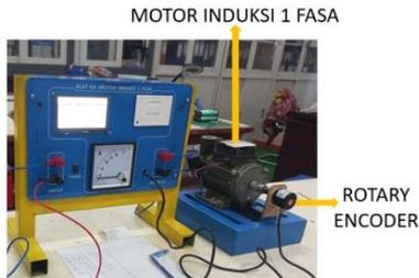
**Gambar 5.** Penempatan Motor dan Rotary Encoder
