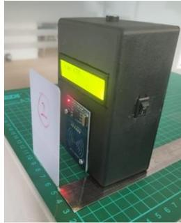
Gambar 10. Pengujian jarak efektif pembacaan RFID Tag
