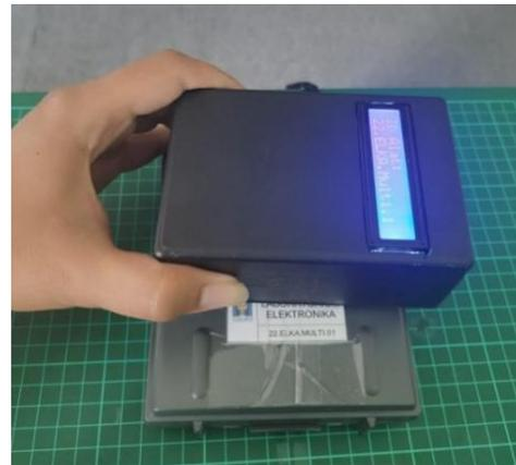
Gambar 9. Proses pembacaan RFID Tag peralatan laboratorium
