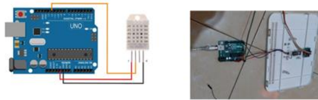
Gambar 2. Interfacing sensor DHT 22 ke arduino.
