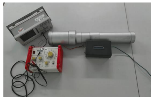
Gambar 3. Rangkaian Alat Ukur Koefisien Serap Bunyi dengan Tabung Impedansi dan Sensor Suara KY-037
