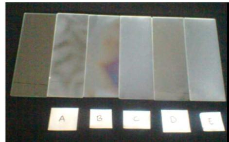
**Gambar 1.** Lapisan tipis (A) TiO<sub>2</sub>, (B) ZnO, (C) ZnO/TiO<sub>2</sub>, (D) TiO<sub>2</sub>:ZnO dan (E) ZnO/TiO<sub>2</sub>:ZnO yang dideposisikan di atas substrat kaca
