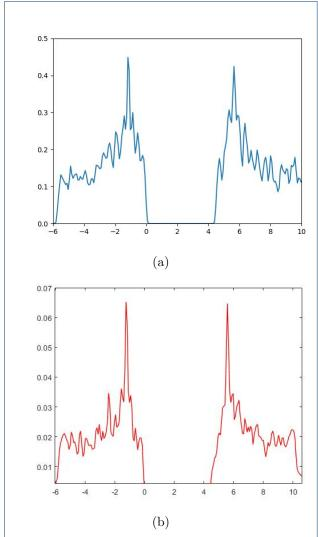
Gambar 5: Rapat Keadaan h-BN ukuran atom  $64 \times$ 64 menggunakan algoritma Trotter Suzuki (a) orde 1 (b) orde 2.
