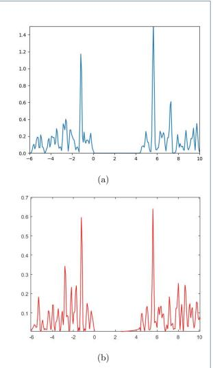
Gambar 3: Rapat Keadaan h-BN ukuran atom  $\mathbf{16} \times \mathbf{16}$  menggunakan algoritma Trotter Suzuki (a) orde 1 (b) orde 2.
