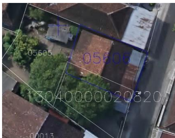
Gambar 3. Bidang tanah yang akan divalidasi terhimpit bidang yang sudah sertifikat elektronik sehingga bentuknya akan tidak sesuai dengan gambar pada surat ukur (sumber: pengamatan sendiri)
