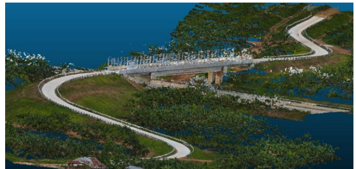
Gambar 4 Point cloud hasil pengolahan fotogrametri
