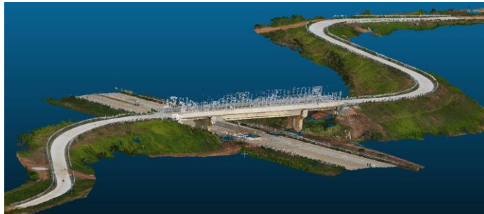
(b) point cloud setelah filtering noise
