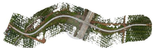
(a) tie point foto udara area main road (tampak atas)
