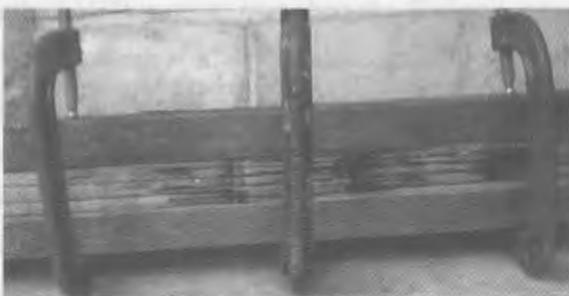
Gambar 1. Pengkleman lapisan bambu
