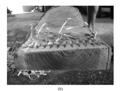
Gambar 1. Pemasangan strain gauge pada bagian permukaan/periferi (a) dan arah radial batang (b)
