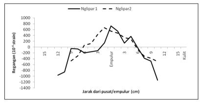
Gambar 6. Pelepasan regangan internal dalam arah radial pohon jati yang tumbuh di tiga tempat di hutan rakyat Gunungkidul.
