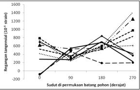
Gambar 2. Pelepasan regangan dalam dua arah pada bagian tepi batang pohon jati dari 3 tempat di hutan rakyat Gunungkidul.
