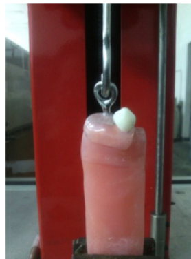
Gambar 3. Pengukuran menggunakan Universal Testing Machine
