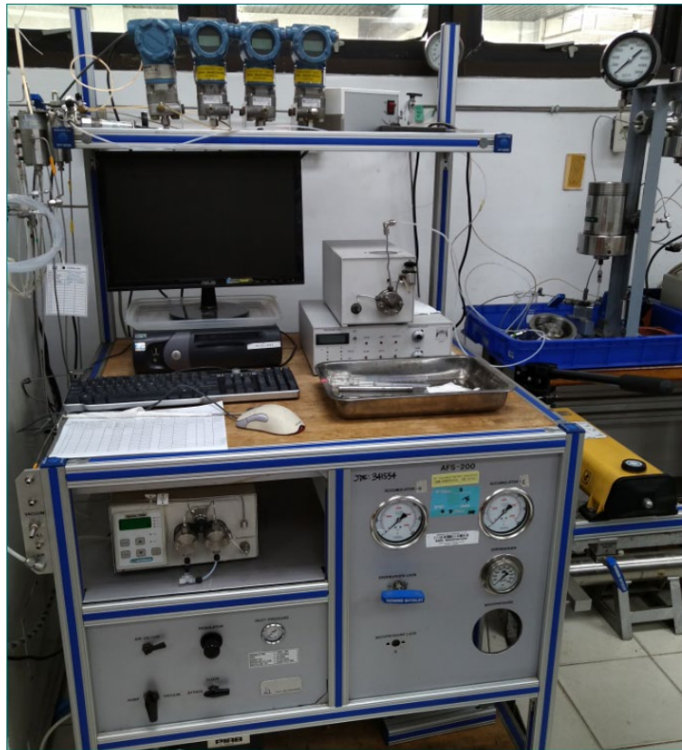
Gambar 4. Alat uji permeability meter AFS200
