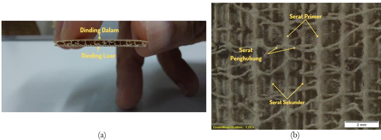
Gambar 7. (a) Slumpring tampak samping. (b) Serat bagian dalam slumpring dilihat dari dinding dalam.
