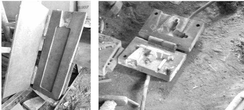
Gambar 8 Cetakan Bilah Gamelan dan Sambungan Pipa yang Terbuat dari Logam
