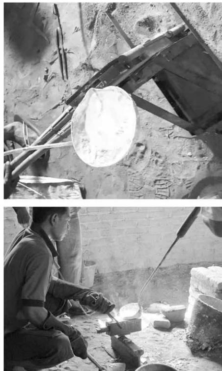
Gambar 13 Penuangan Cairan Logam Kuningan ke dalam Cetakan
