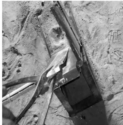
Gambar 15 Proses Pembongkaran Hasil Pengecoran dari Cetakan
