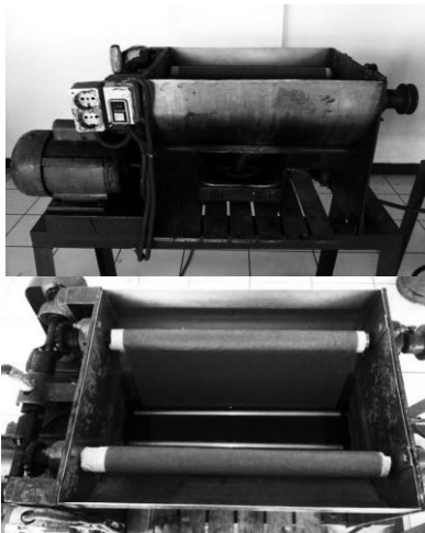
Gambar 5 dan 6. Proses pewarnaan pada mesin jigger
