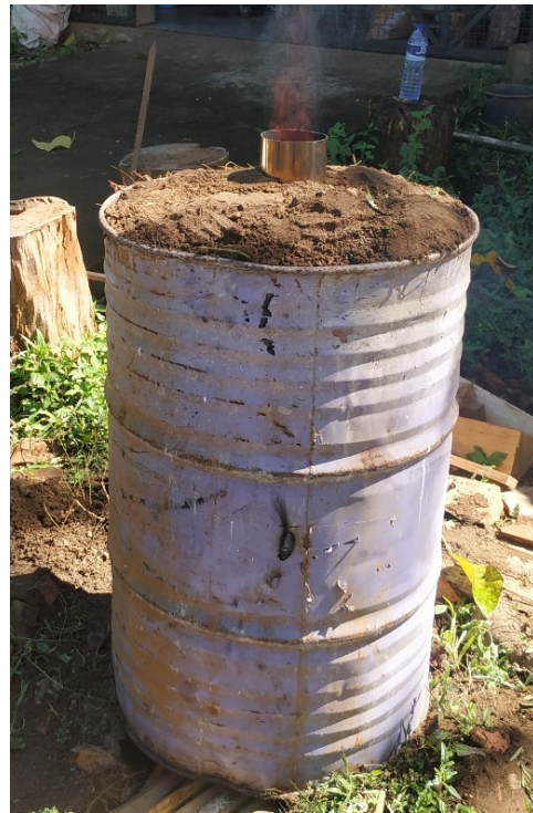
GAMBAR 1. Pembuatan arang tempurung kelapa dengan kiln drum .
