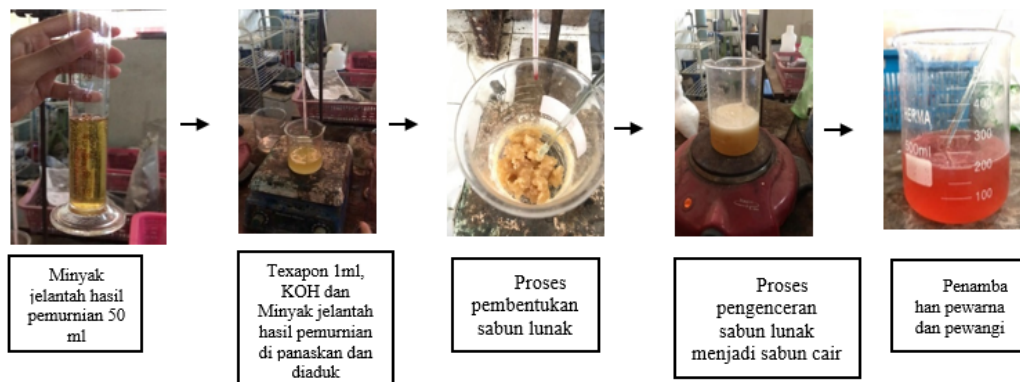
(c) Pembuatan sabun cair cuci tangan dari minyak hasil pemurnian
