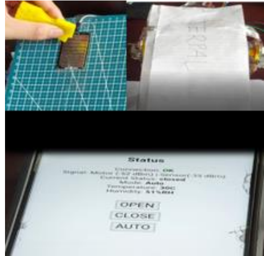
Gambar 8. Pengujian pengindraan raindrop sensor
