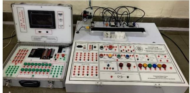
Gambar 15. Hasil Perancangan *Conveyor Trainer Module*
