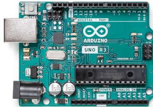
Gambar 2. 4 Arduino Uno<sup>[8]</sup>
