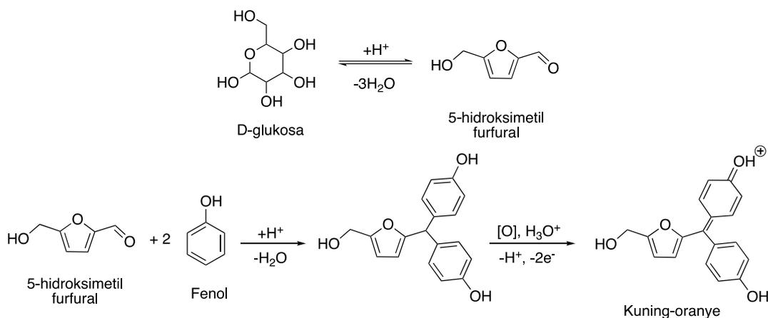
**Gambar 1. Reaksi Kolorimetri Glukosa dengan Reagen Fenol-Asam Sulfat**
