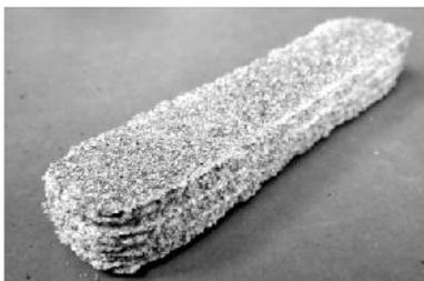
**Gambar 12.** *Green specimen* untuk uji lentur terbentuk (tersusun) dari 10 lapis (*layer*).
