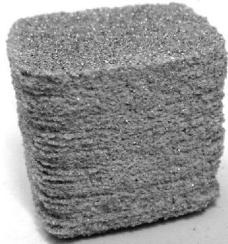
**Gambar 13.** *Green specimen* untuk uji kesalahan dimensi (*dimensional error*), terbentuk (tersusun) dari 30 lapis (*layer*).
