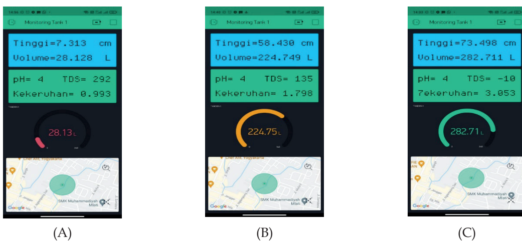
Gambar 7. Tampilan Sistem Informasi berbasis Android dengan (A) warna merah menunjukkan volume air dibawah batas akhir, (B) warna kuning menunjukkan volume air berada ditengah batas, (C) warna hijau menunjukkan volume air penuh serta dalam tampilan tersebut disajikan informasi kualitas air dan titik lokasi Sumber: Dokumentasi peneliti
