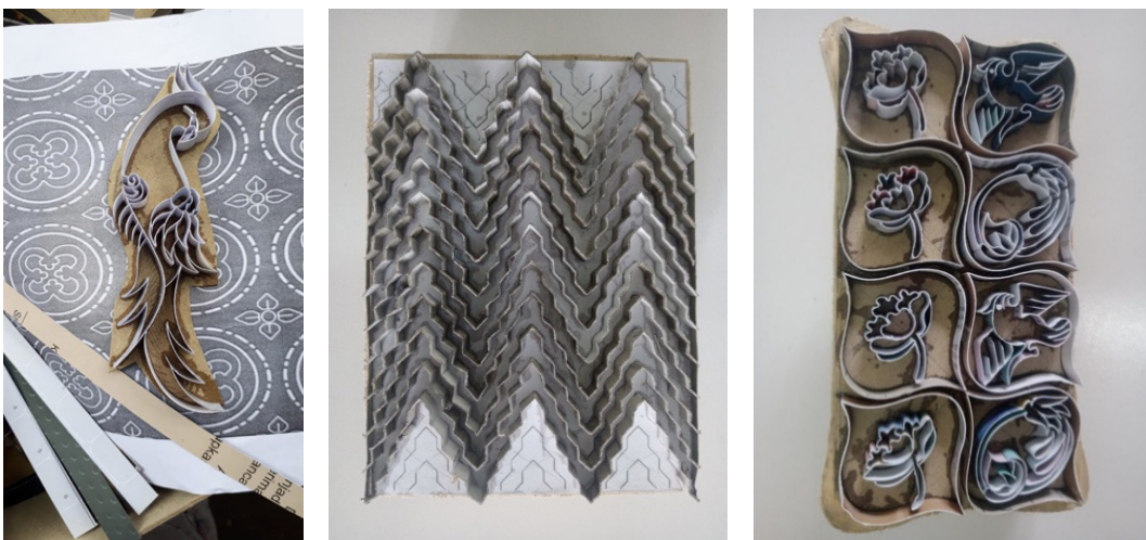
Gambar 7. Beberapa contoh cetakan motif batik yang terbuat dari kertas duplex . Sumber: Tim PkM Banyunibo 2021.
