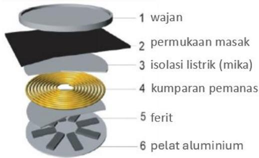
Gambar 1. Komponen kompor induksi.
