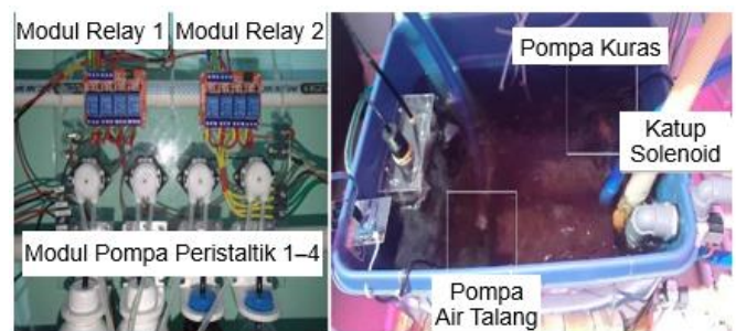
Gambar 5. Modul aktuator sistem hidroponik otomatis.
