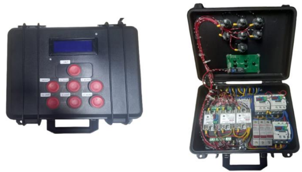
Gambar 7. Tampilan komponen kendali: modul ESP32, sistem keamanan listrik, dan distribusi arus.
