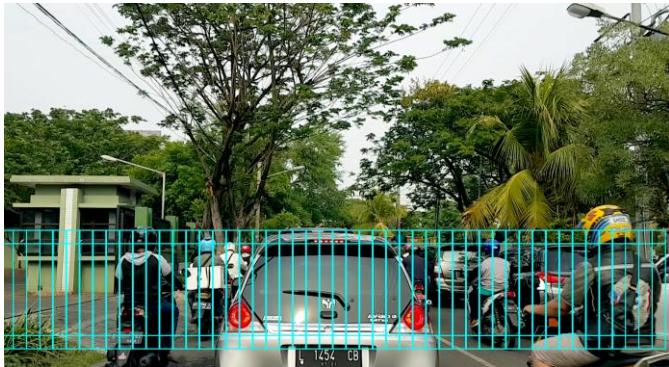
Gbr. 5 Sliding window dengan ukuran 150x300 piksel.
