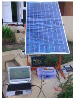
Gbr. 11 Pengujian sistem MPPT.
