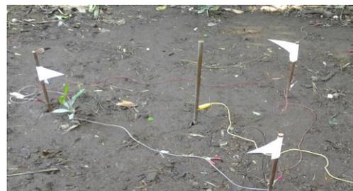
Gbr. 9 Foto pengukuran resistans pentanahan satu batang pentanah dengan elektrode sangkar delta tiga batang penyusun.
