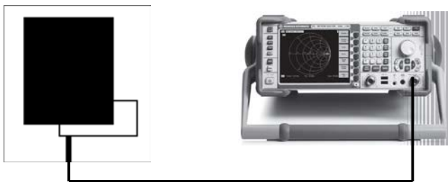
Gbr. 11 Rangkaian untuk pengukuran parameter-parameter menggunakan Network analyzer R&S ZVL.
