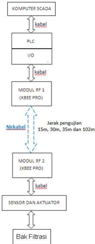
Gbr. 15. Blok diagram skema pengujian jangkauan sistem sensor dan aktuator nirkabel
