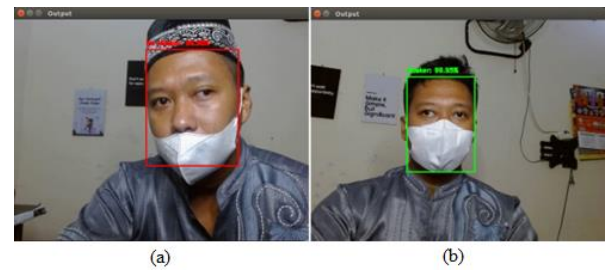
Gambar 3. Hasil pengujian deteksi masker terhadap model menggunakan masker, (a) tanpa menutup hidung, (b) menutup hidung.
