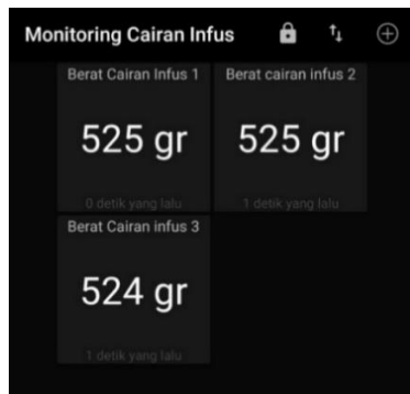
Gambar 3. Tampilan sistem pada aplikasi MQTT Dash.
